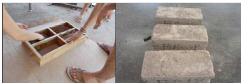
Figura 3. Deposito da massa dos tijolos na forma.
