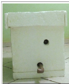
Figura 3. Reservatório térmico de isopor
