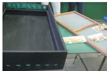
Figura 2. Vista da estrutura interna do secador solar- caixa preta, e tela para distribuição das fatias.
