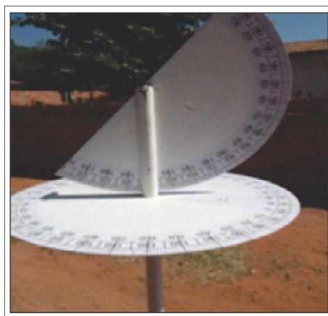
Figura 3: Equipamento para medição de Azimute e Altura ou Distância Zenital de corpos celestes.
