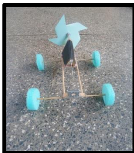
Figura 1. Carrinho com hélice de 10,99\text{cm} de diâmetro.
