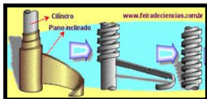
Figura 2. Comparação do parafuso com um plano inclinado.
