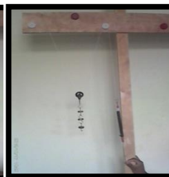
Figura 3. Força aplicada sobre o corpo com uma roldana fixa e outra móvel.
