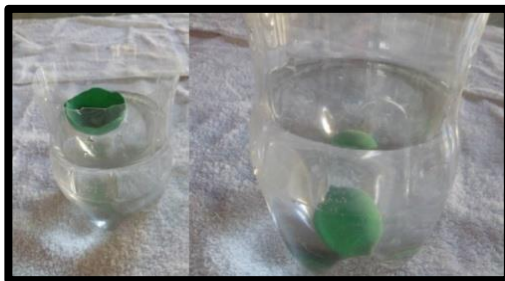
Figura 3. Flutuação do mesmo corpo, com área de contato diferente.
