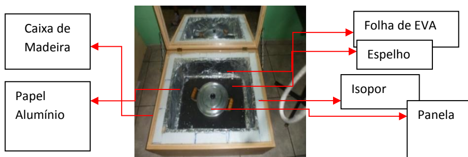
Figura 1. Esquema do forno solar e materiais utilizados na montagem do mesmo.
