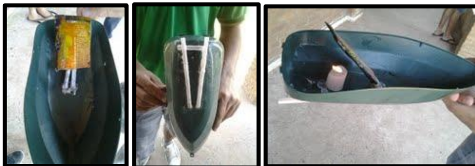
Figura 1. Barco a vapor confeccionado com placa metálica e canudo plástico
