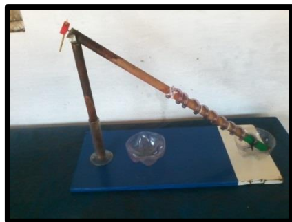
Figura 4. Parafuso de Arquimedes construído, com base no modelo de Da Vinci.
