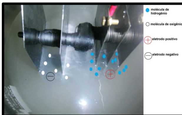
Figura2. Formação das moléculas de hidrogênio e oxigênio nos eletrodos.
