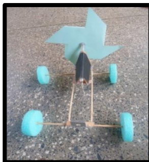
Figura 2. Carrinho com hélice de 15,7\text{cm} de diâmetro.
