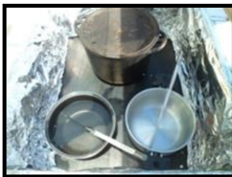
Figura 2. Panelas de alumínio, alumínio revestida de preto e de ferro com água dentro do forno solar.
