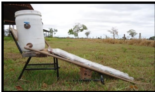
Figura 2. Coletor com garrafa Pet e embalagens Tetra Pak, com inclinação de 15°.
