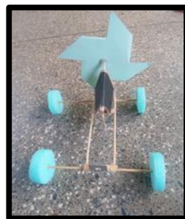
Figura 3. Carrinho com hélice de 22\text{cm} de diâmetro.
