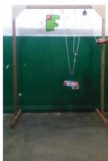
Figura 2. Sistema com uma roldana fixa e duas móveis.
