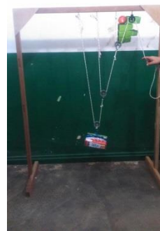
Figura 3. Sistema com uma roldana fixa e três móveis.
