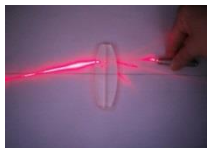
Figura 1. Comportamento da luz na lente convergente.
