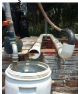
Figura 1. Sistema De Bombeamento De Líquido / Chorume De Fezes Bovinas.
