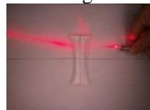
Figura 2. Comportamento da luz na lente divergente.
