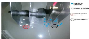
Figura 2. Esquema de formação das moléculas de hidrogênio e oxigênio nos eletrodos
